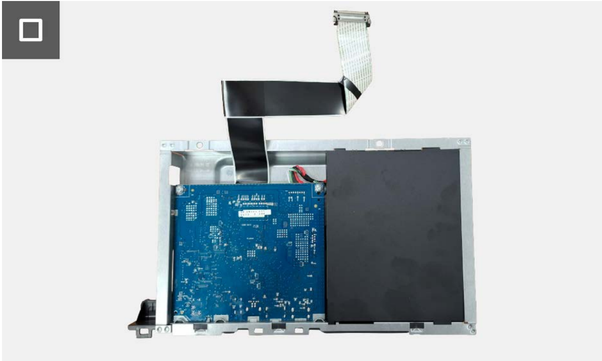
Figura 11. Retirar el protector metálico
