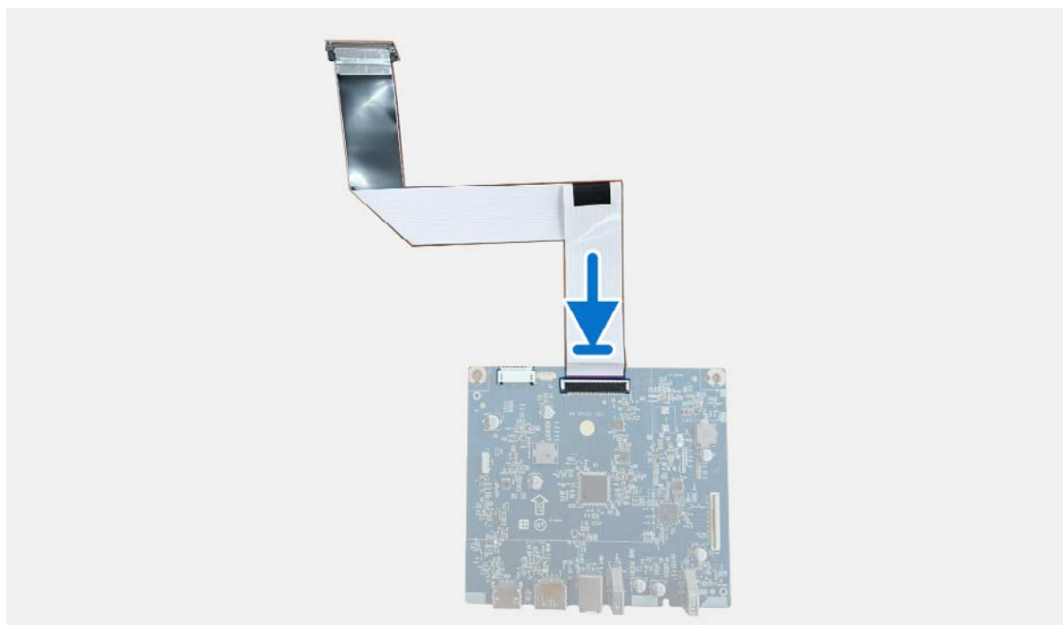
Figura 23. Instalar la placa de la interfaz
