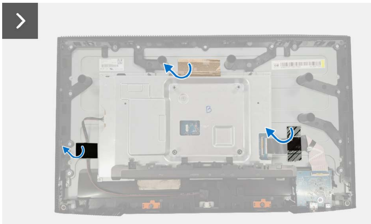
Figura 8. Retirar el protector metálico
