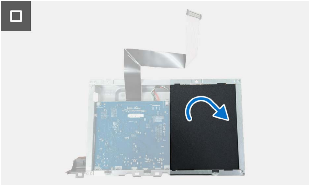
Figura 21. Instalar la placa de alimentación
