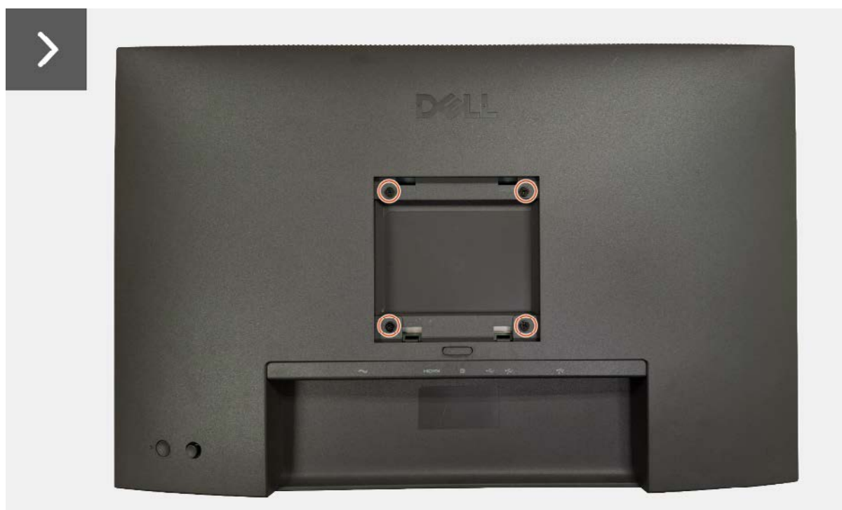
Figura 3. Retirar la cubierta posterior
