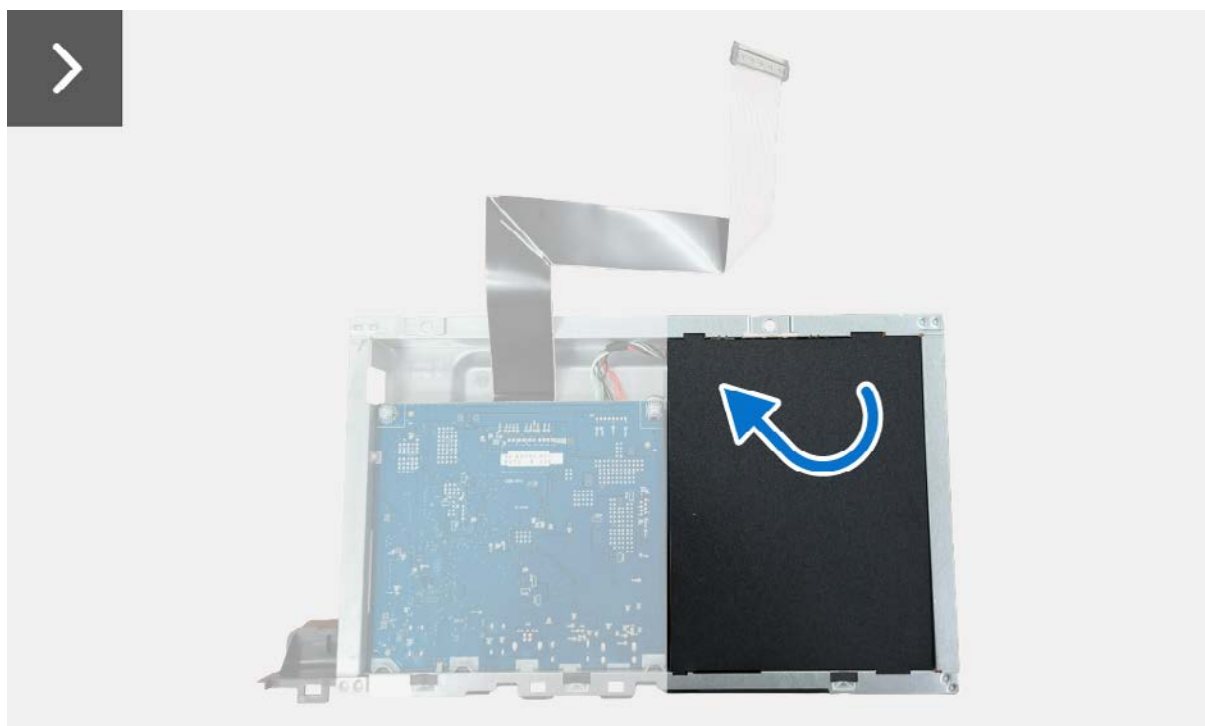
Figura 16. Retirar la placa de alimentación
