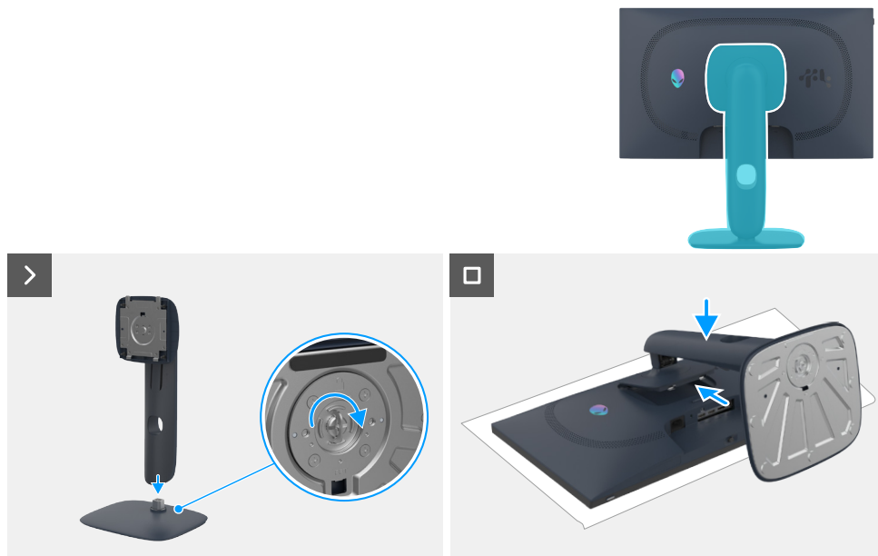
Figura 10. Instalación del soporte
