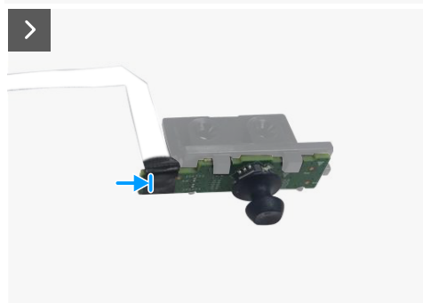
Figura 16. Instalación de la placa del Joystick
