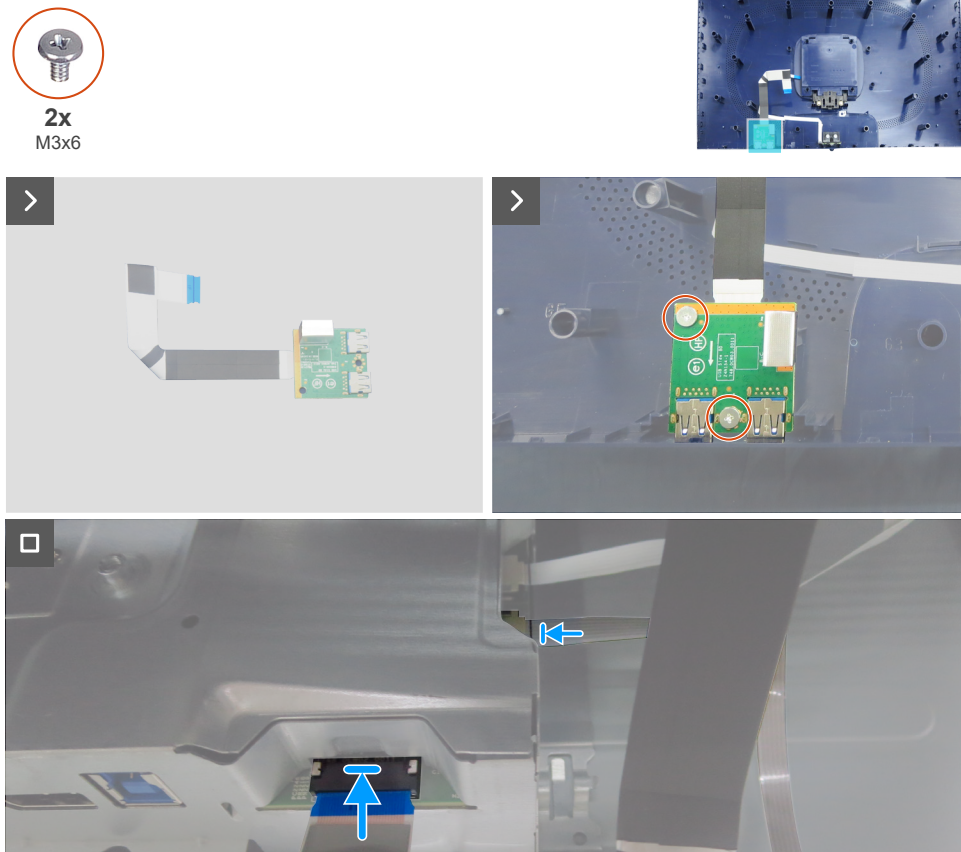
Figura 14. Instalación de la placa USB
