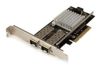
Obtenga una conectividad rápida y de gran ancho de banda con esta rentable tarjeta de red de fibra. Añade dos ranuras SFP+ abiertas a su servidor o estación de trabajo de alta potencia, ofreciéndole una forma sencilla de conectar su servidor o estación de trabajo a una red de fibra de 10 Gigabits utilizando los módulos SFP+ de su elección.
