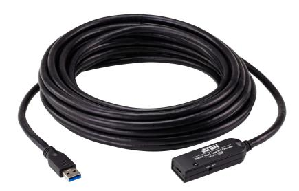
El UE331C es un cable extensor USB 3.2 de primera generación que permite ampliar en 10 m la conexión entre un ordenador portátil o de sobremesa con conexión USB de tipo A y un dispositivo USB-C. Gracias a su velocidad de transferencia de datos Super Speed de hasta 5 Gbps, el UE331C es compatible con los estándares USB 2.0 y 1.1, lo que garantiza unas comunicaciones de datos fiables.
