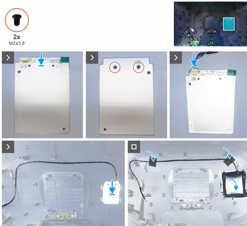
Figura 14. Instalación del módulo de retroiluminación
