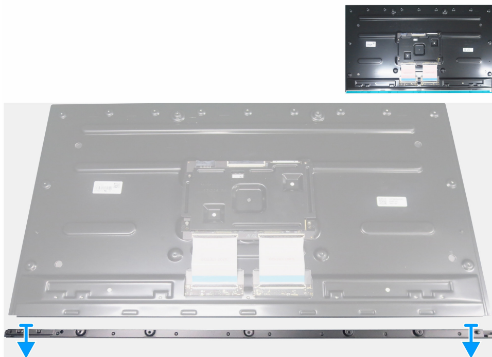
Figura 25. Desmontaje del embellecedor frontal
