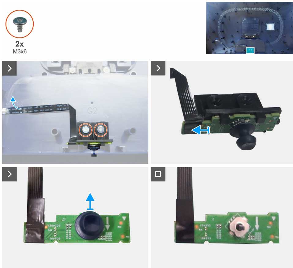
Figura 17. Desmontaje de la placa del joystick
