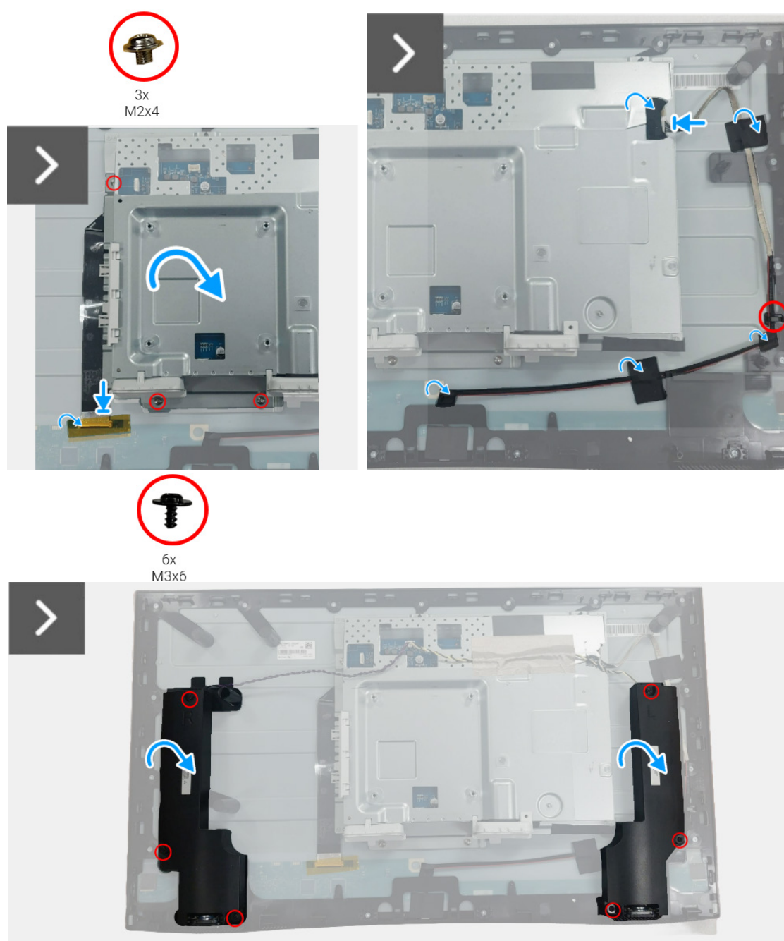
Figura 9. Instalar el conjunto de la placa de la interfaz
