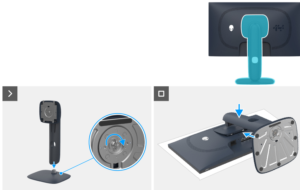
Figura 2. Instalación del soporte
