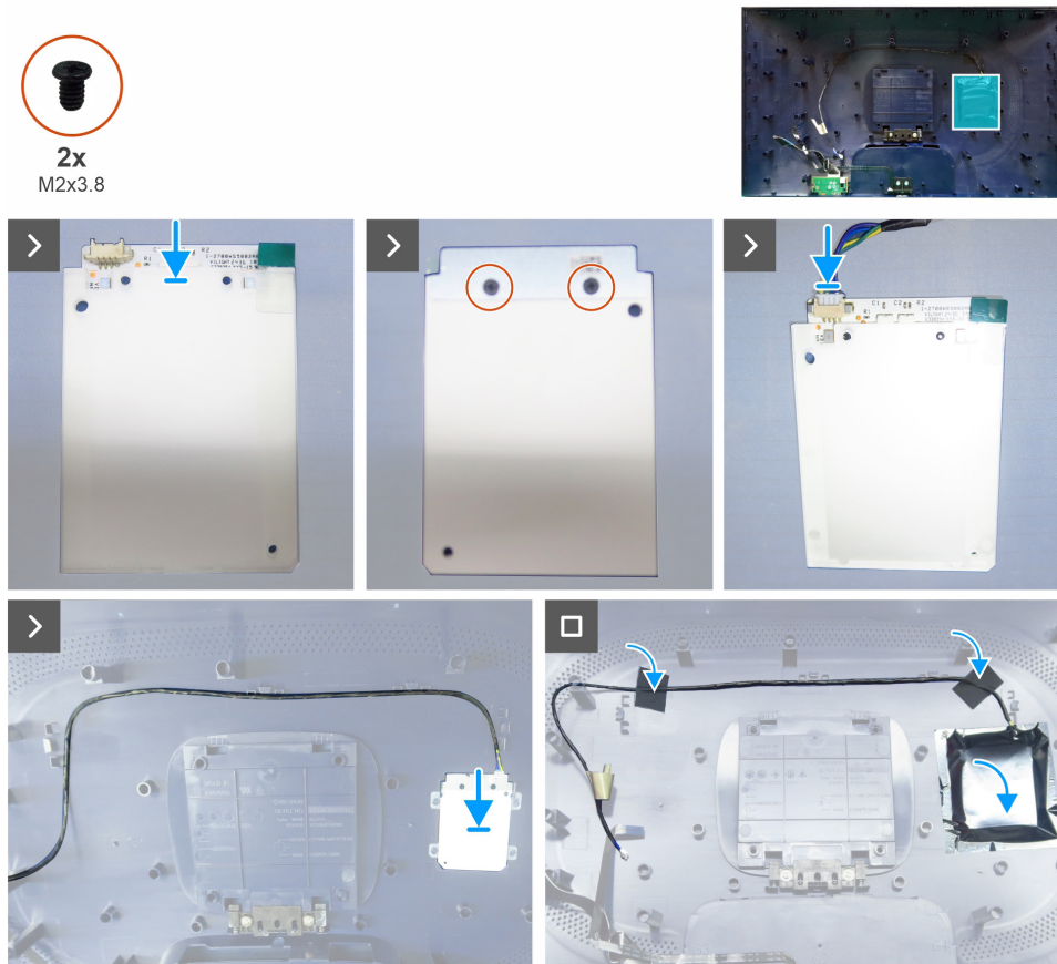
Figura 6. Instalación del módulo de retroiluminación
