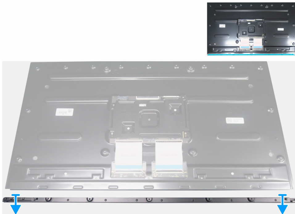
Figura 17. Desmontaje del embellecedor frontal
