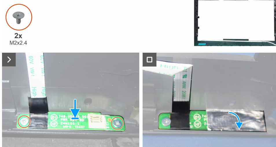
Figura 16. Instalación de la tablero de teclado
