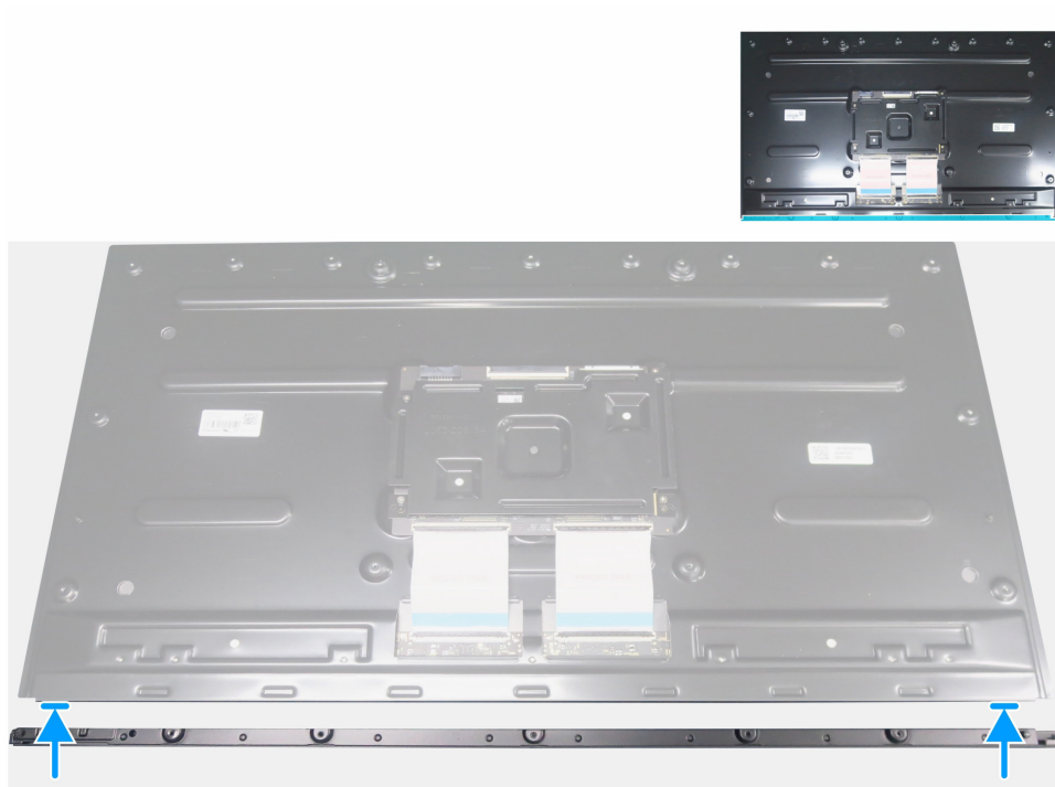
Figura 18. Instalación del embellecedor frontal
