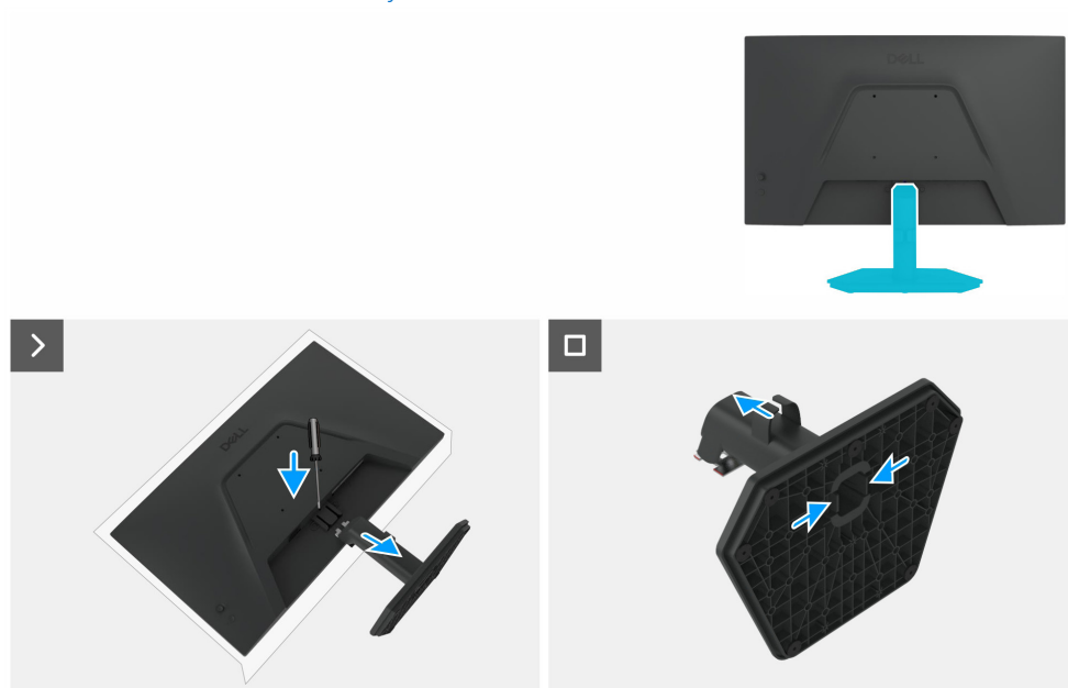
Figura 1. Desmontaje del soporte
