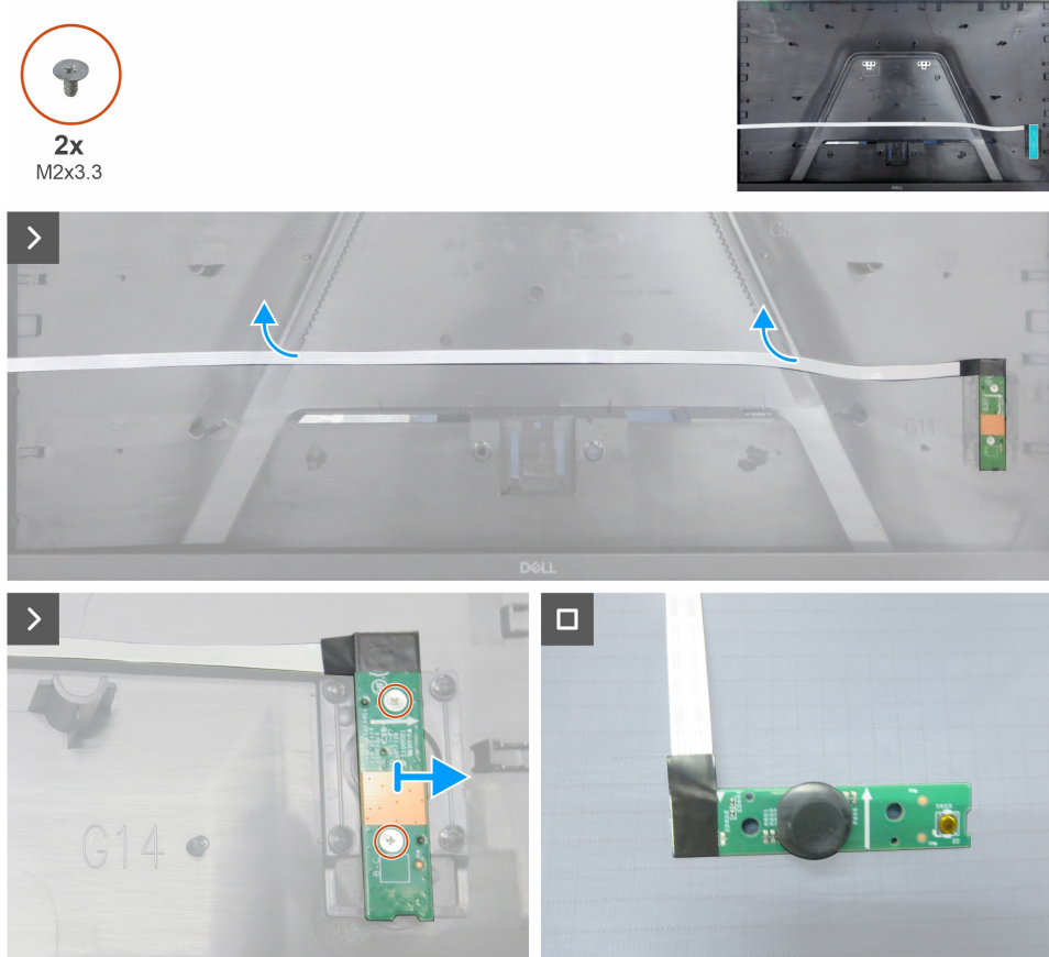
Figura 7. Desmontaje de la placa del teclado
