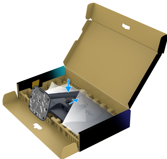
Figura 14. Deslice las pestañas del elevador del soporte en las ranuras
