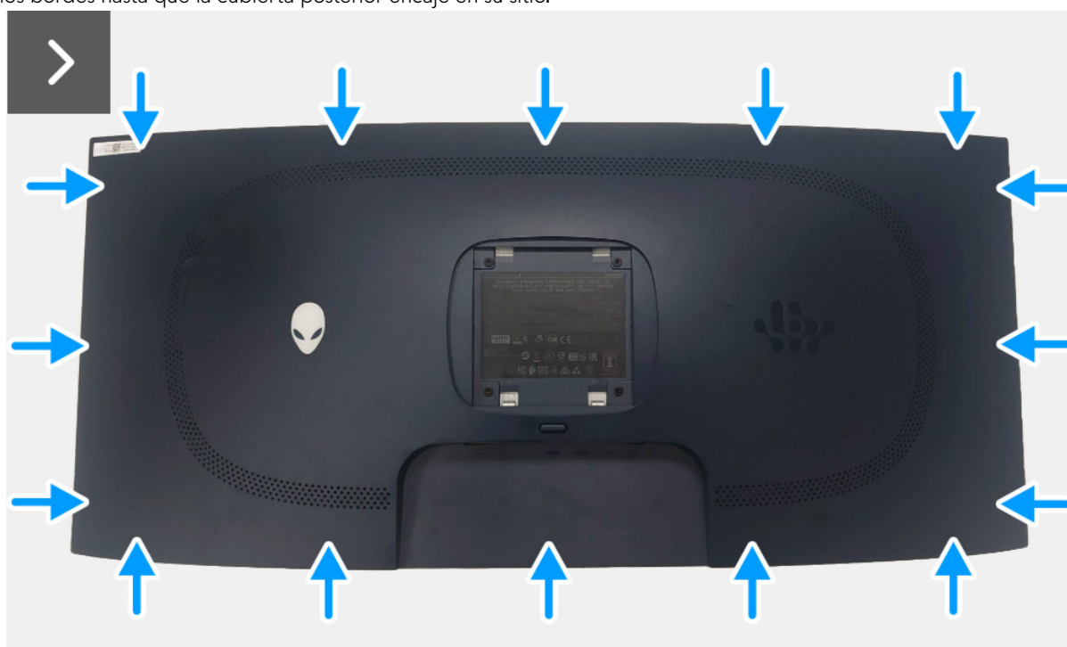
Figura 8. Instalar la cubierta posterior
