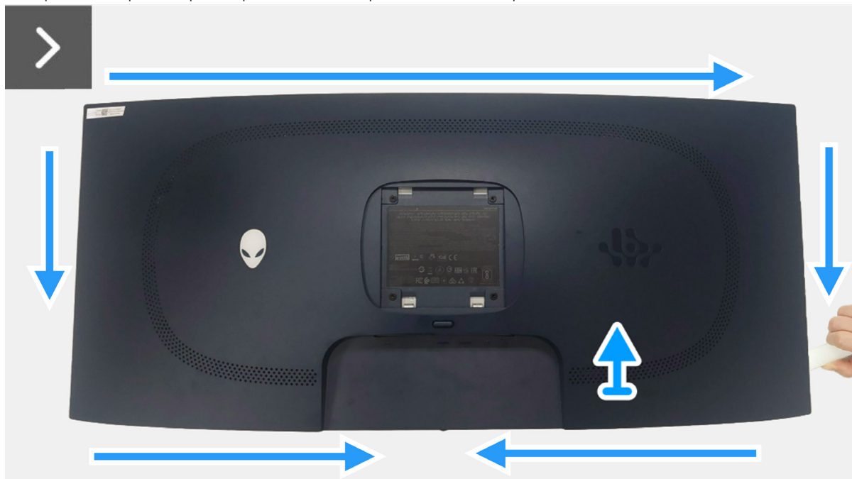
Figura 5. Retirar la cubierta posterior
