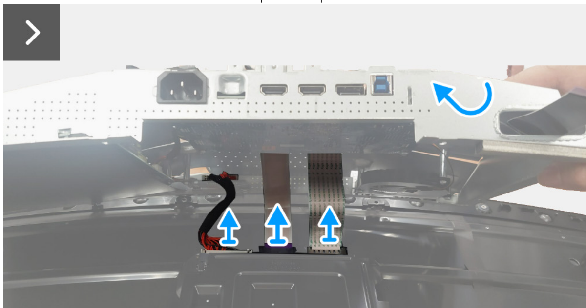
Figura 12. Retirar el protector metálico
