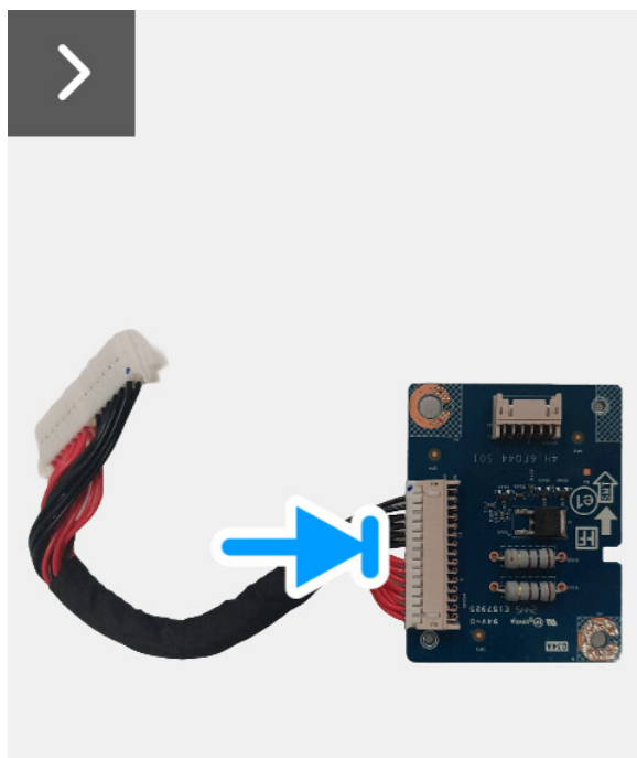
Figura 27. Instalar la placa DC-DC
