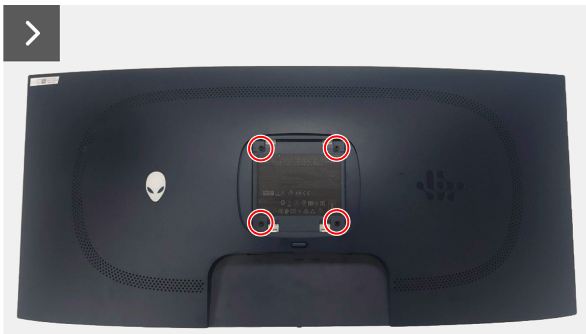
Figura 4. Retirar la cubierta posterior
